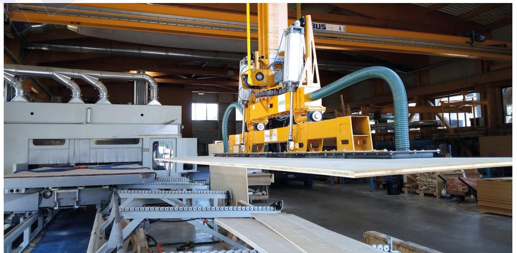
**LP Charpente utilise le préhenseur pour alimenter et décharger ses deux centres d'usinage avec panneaux, murs et poutres.**
