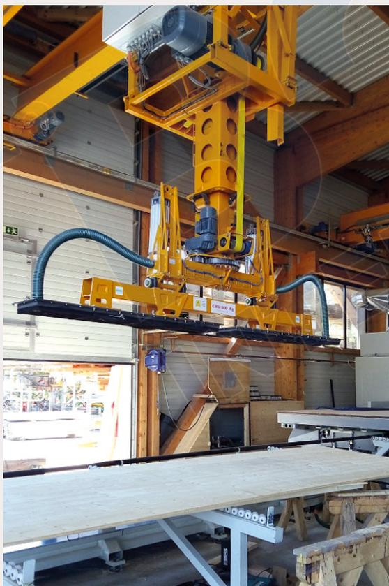
**"Nous avons fabriqué pour la société LP Charpente des préhenseurs sans clapets afin de réduire les fréquences de nettoyage et de maintenance et donc les coûts afférents", souligne Alexandre Atroun, gérant de Mousse Process.**
